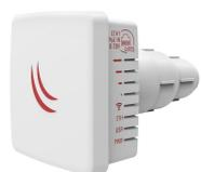
Le LDF (Lite Dish Feed) est un point d'accès sans fil extérieur doté d'une antenne intégrée, destiné à être installé sur des antennes paraboliques décalées par satellite. Le plat servira de réflecteur, amplifiant le signal.
