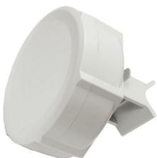
SXT 6 est notre premier produit pour la fréquence 5.9-6.4GHz sous licence. Equipé d'une licence RouterOS niveau 4 et d'une antenne 16dBi à double chaîne de 28 degrés, l'unité peut être utilisée comme station de base ou CPE, et deux d'entre eux peuvent être utilisés pour créer une liaison point à point.
