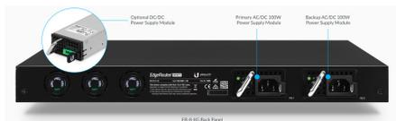
L'EdgeRouter Infinity comprend deux modules d'alimentation AC/DC. Vous avez la possibilité de remplacer par un module d'alimentation DC/DC.
