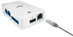
**Ubiquiti mSensor:** Ubiquiti vous offre une variété de détecteurs à connecter à votre mPort et votre réseau mFi. Ces détecteurs se connectent au mPort à travers un câble RJ45 standard – à l'exception du mFi-DS qui se connecte en utilisant un connecteur bloc terminal.
